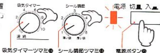
**4** 袋にキレイな水(約200cc)を入れ、ノズルにセットしシールバー⑦を押す。ポンプが作動し、袋の水を吸引し、ハイスイホースから排水します。(1~3回繰り返しておこなう。) 袋の底を持ち上げると吸引しやすくなります。
